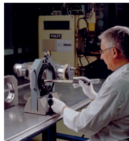
10: Transferencia del diámetro de la pista de rodadura al instrumento de medición
