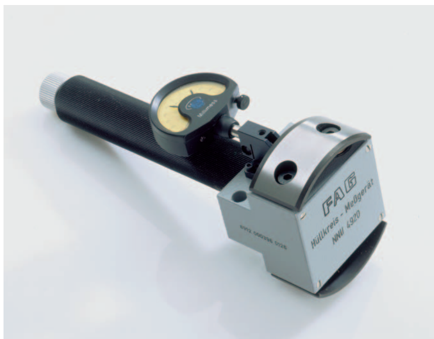
14: Instrumento de medición de círculo límite FAG MGI 21 para ajustar el juego radial o la precarga de rodamientos de rodillos cilíndricos con anillo interior desmontable.
