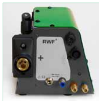
RWF 2 – Alimentador compacto para MIG con sistema de alimentación de alambre de cuatro rodillos y control electrónico de la velocidad de alimentación del alambre.
