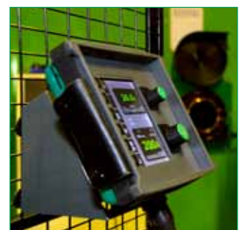
Mando a distancia MIG 2 - Control remoto de la pantalla gráfica.
