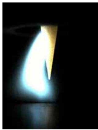
Tungsteno de baja calidad: típico encendido de arco lateral, el arco parpadea y da vueltas lentamente alrededor de la punta del electrodo que se debe cortar y reafilar.
