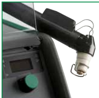
Antorcha de corte plasma para Zeta 60, manguera 6 m Art. no.....80690091
