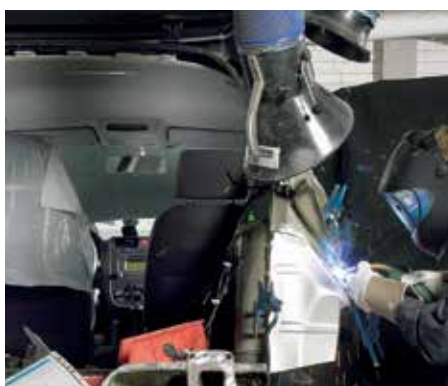
Soldadura MIG/MAG en chapa de metal
