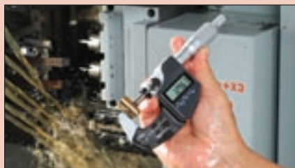
Tambor de fricción (con fricción continua del tambor)
