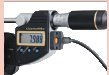
Ejemplo de utilización con cable de señales (Accesorios opcionales)
