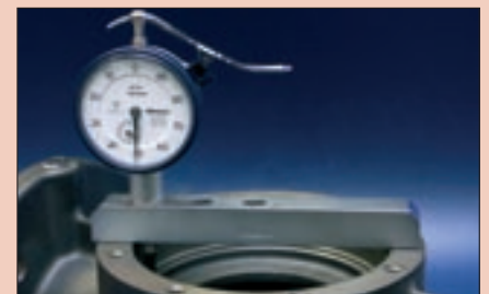
Reloj comparador con puente de profundidad nº 7221 en la aplicación
