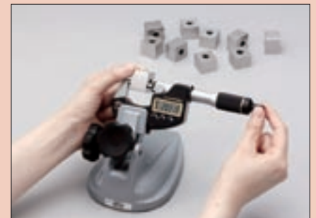
Ejemplo de utilización con soporte de medición 156-101 M (Accesorios opcionales)
