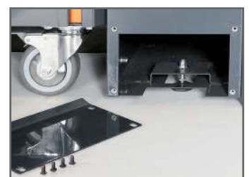
Pies de apoyo ajustables en altura para adaptarse a superficies irregulares
