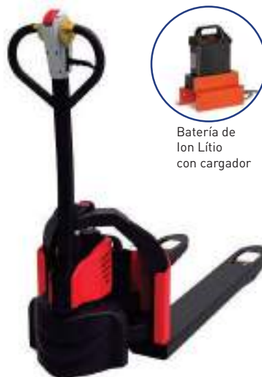
Motor tracción 0,65 kW Rueda Ø210x70mm
