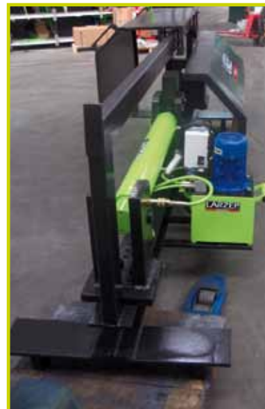
Prensa para ruedas de 23 Tn de capacidad y 800 mm de carrera.
