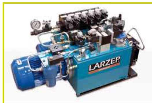
Grupo eléctrico de 50 litros con 6 salidas paralelas.
