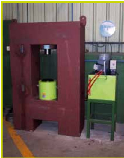
Prensa de 30 Tn de capacidad con grupo eléctrico de 50 litros y 4 vías.
