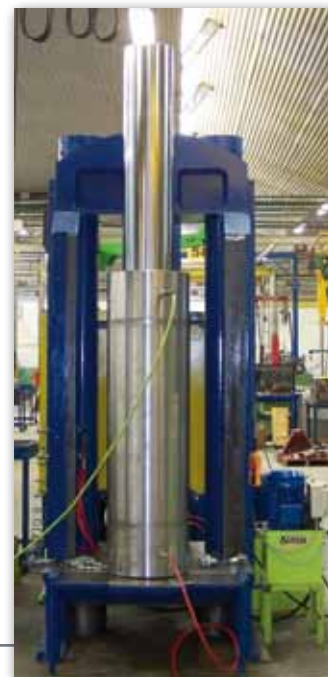
Larzep diseña y fabrica cilindros especiales de carrera larga bajo demanda.
