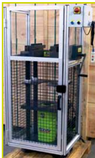
Prensa de 140 Tn y 250 mm de carrera con protección especial.
