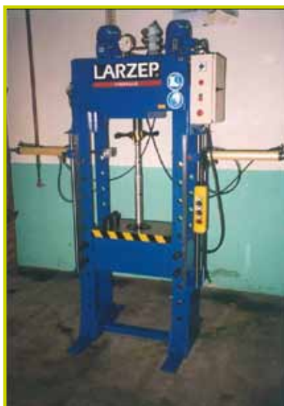
Prensa de precisión para producción con sistemas de seguridad.
