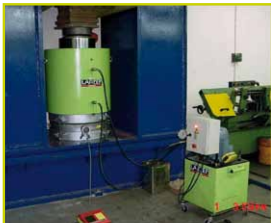
Prensa de alto tonelaje de 1.500 Tn de capacidad con grupo eléctrico de 50 litros con electroválvula.
