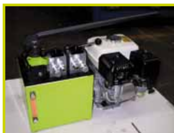
Grupo de gasolina de 10 litros con bomba manual de emergencia y 2 válvulas direccionales.
