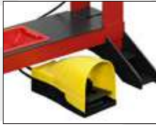
Los modelos NF son accionados por aire mediante el pedal
