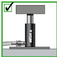
No permita nunca que los cilindros se levanten del suelo sujetándolos por los acoplamientos.
