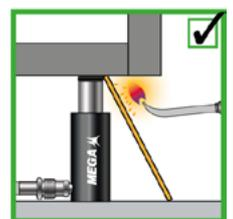
Mantenga el equipo hidráulico alejado de llama abierta y de temperaturas por encima de 65°C (150°F).
