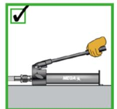
No use prolongadores con las palancas. Si se usan correctamente, las bombas de mano operan con facilidad.
