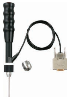
Detector UD-413 Uselo para piezas cóncavas, como dientes de engranajes, rodamientos de bolas, etc.
