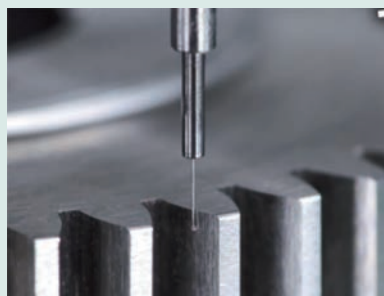
MPP-NANO Módulo 0.8 medida de engranajes maestros
