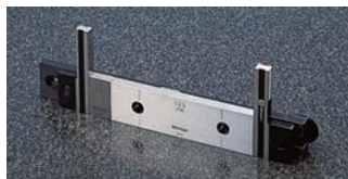
Bidas B y C : Usadas para acoplar dos bloques patrón largos con otros bloques hasta 35 mm (Brida B) or 140 mm Brida C). También empleado para adaptar bocas con dos adaptadores. Brida B : 619032 (R max.= 90 mm- L= 126 mm) Brida C : 619033 (R max.= 200 mm- L= 236 mm)
