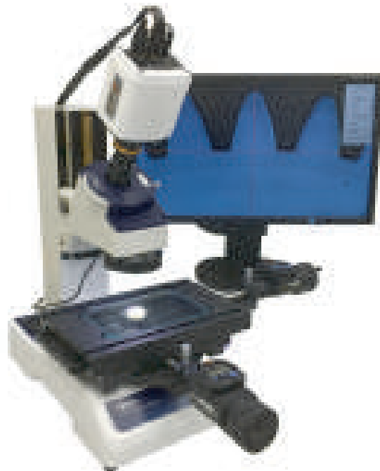
TM-1005B con anillo de luz LED opcional (63AAA001), adaptador ocular 0.37X (63AAA060) y cámara digital HDMI (63AAA059)
