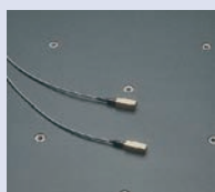
Sistema de compensación de temperatura (sensores de temperatura)
