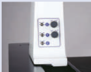
Bloqueo neumático de un solo impulso y avance fino para posicionamiento rápido
