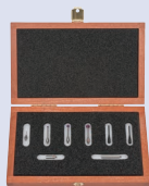
Calibración de MMC usando un patrón de cristal de dilatación térmica cero.
