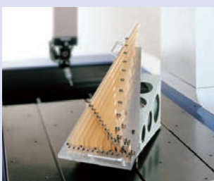
Calibración de MMC usando un patrón de cristal de dilatación térmica cero.
