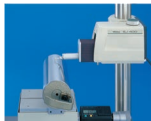
Medición de la superficie R
