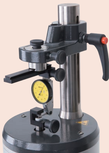
Calibración de comparador de palpador oscilante con accesorios opcionales
