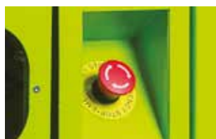
Hueco para pulsador de emergencia externo
