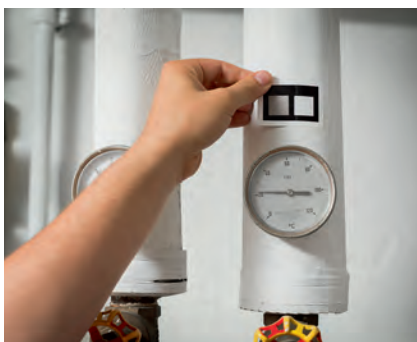
Pegue el testo \epsilon -marker y capte el objeto con la cámara digital de la cámara termográfica.
