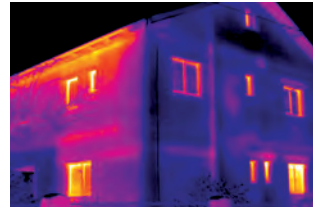
Detección de las pérdidas de energía en edificios: visualización y medición inmediatas de puentes térmicos en fachadas o en la envolvente.
