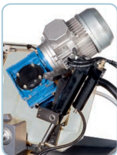
Bajada hidráulica (K-280-M-BH) Hydraulic descent (K-280-M-BH)
