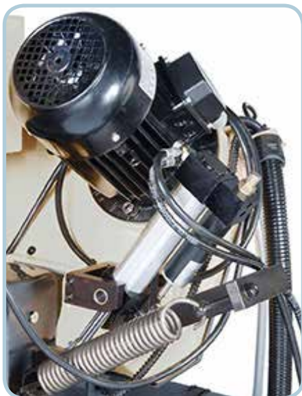
Bajada hidráulica (K-300-M-D/I-BH) Hydraulic descent (K-300-M-D/I-BH)
