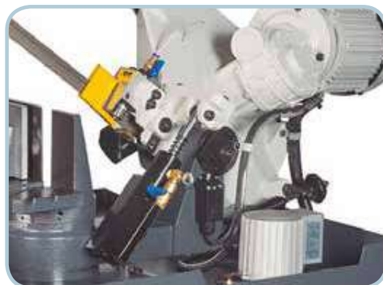
Bajada hidráulica (CY-270-N-BH) Hydraulic descent (CY-270-N-BH)
