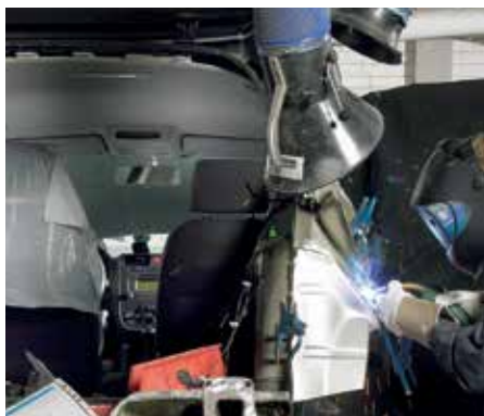
Soldadura MIG/MAG en chapa de metal
