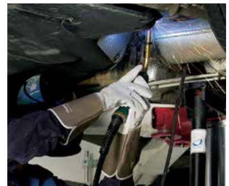
Control de ajuste de los parámetros de soldadura con el diálogo de la antorcha
