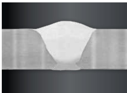
Cordón de raíz IAC soldado en posición vertical descendente en acero suave de 10 mm; completado con dos cordones de Repetición de secuencia en posición vertical descendente.
