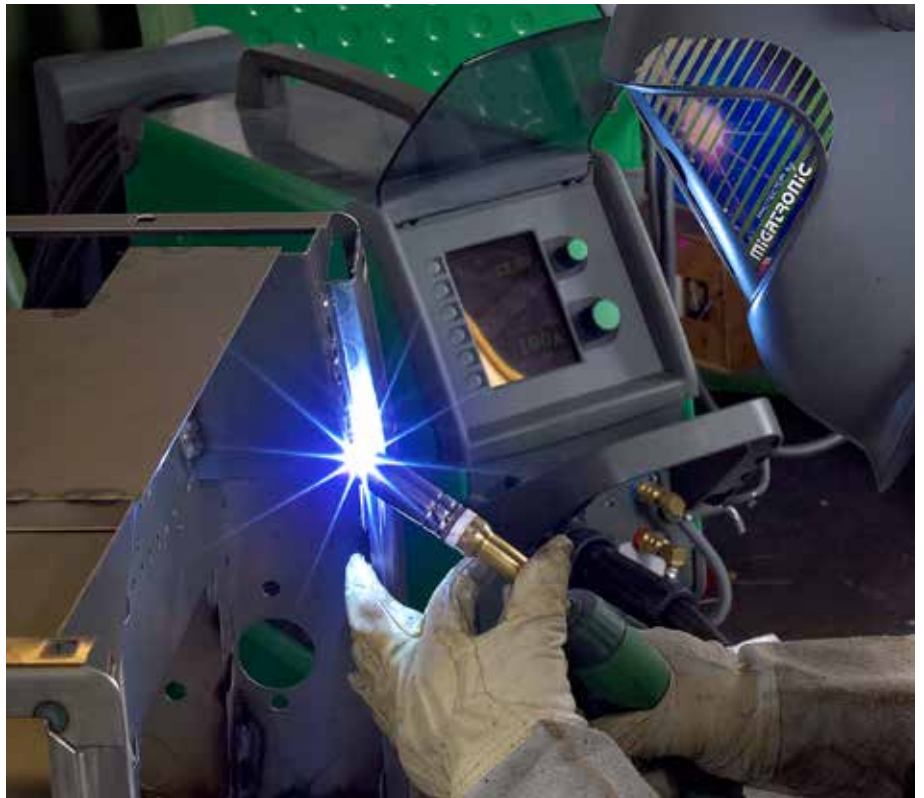
Sigma Galaxy incorpora un ordenador potente que ajusta el proceso 50.000 veces por segundo.
