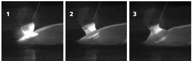
IAC™ - Soldadura vertical descendente de un cordón de raíz en una tubería de calefacción urbana. Aumento significativo de la velocidad de soldadura comparado con la soldadura tradicional ascendente.
