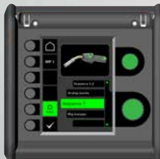
Elección de la antorcha en el menú principal; Galaxy es compatible con todas las funciones de soplete MIG-A Twist.
